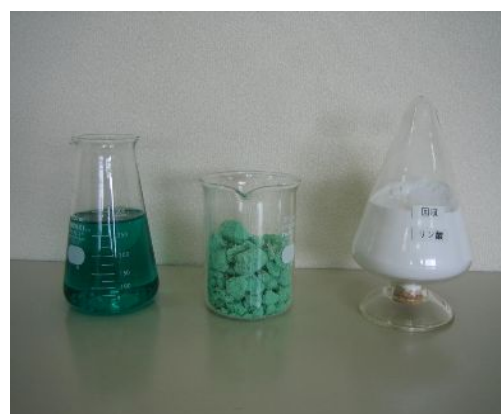
(上図)左から順に、無電解ニッケルメッキ廃液脱水固化したニッケル化合物、粉末状に加工したリン
