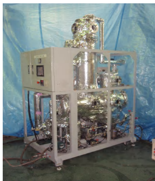
ヒートポンプ式テスト機 蒸発能力 max 2Ton/Day
