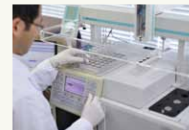
排水や廃棄物中の 1,4-ジオキサンを分析するガスクロマトグラフ質量分析計
