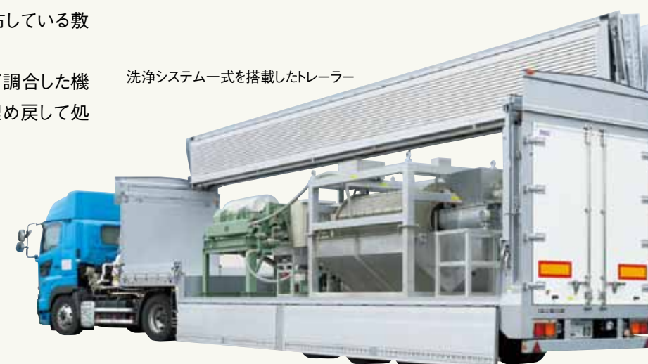
汚染土壌 脱水後、洗浄液は再利用 洗浄済み土壌（埋め戻し）
