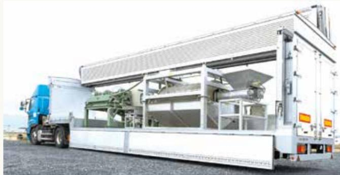
自社開発した土壌中の有害物質を効率的に液中に溶出する化学洗浄技術で、これまで困難とされたセレンや鉛、ほう素、ふっ素、六価クロム等、第二種特定有害物質による高濃度汚染土壌の「現地洗浄」を実現します。土壌搬出のない現地処理は環境負荷が低いことはもちろん、搬出や埋め戻し等に掛かるコストも大幅に削減が可能です。
