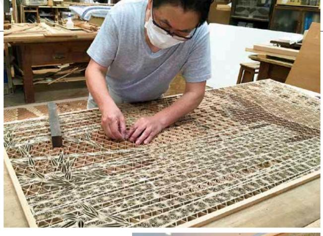
引き戸、欄間、障子、衝立、現代建築のインテリアなど用途に応じた多様な機能性とデザインを生み出すのは精緻な手わざ。栄建具工芸では親方含め20~70代の職人5人が活躍し、一人で全工程をこなします。製品によりサイズも組み付けるパーツの数も大小さまざま。大型のものは役割分担し、1年以上かけてつくり上げることもあります。組子の完成度はもちろん、建具としての収まりや使い勝手にもプロのわざが発揮されます。
