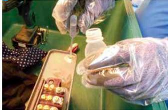
蛍光灯安定器・水銀灯安定器・変圧器・コンデンサについて、PCBや成分不明の化学物質が漏えい、気化、混触している可能性がある現場でも、化学知識を持ったスタッフが対象物に応じた最適な手法で安全にサンプリング、調査を行います。
