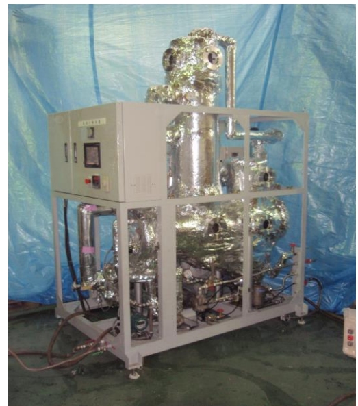
ヒートポンプ式テスト機
