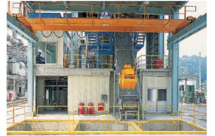
①投入口／高発熱量の廃油は工場で調整後、助燃剤として使用します。固形物は安定燃焼のために、調整を行う必要があります。油泥ピットで廃棄物同士を混合し、熱量、水分等の調整を行った後に、炉内にプッシャーで投入します。ただし、事故防止のため、反応性のある廃棄物は混合せず、直接炉内に投入します。
